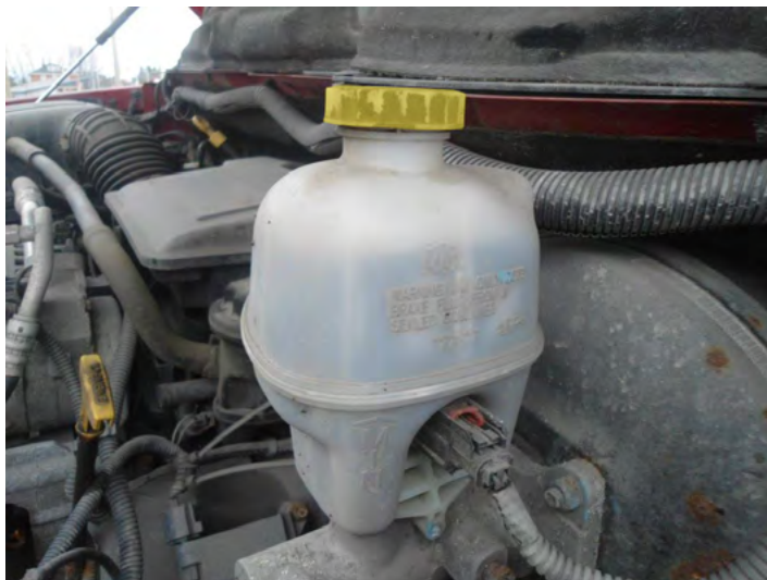
FIGURE 56 | Réservoir du maître-cylindre d'un camion
