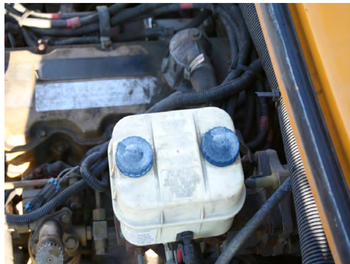
FIGURE 57 | Réservoir du maître-cylindre d'un autobus scolaire
